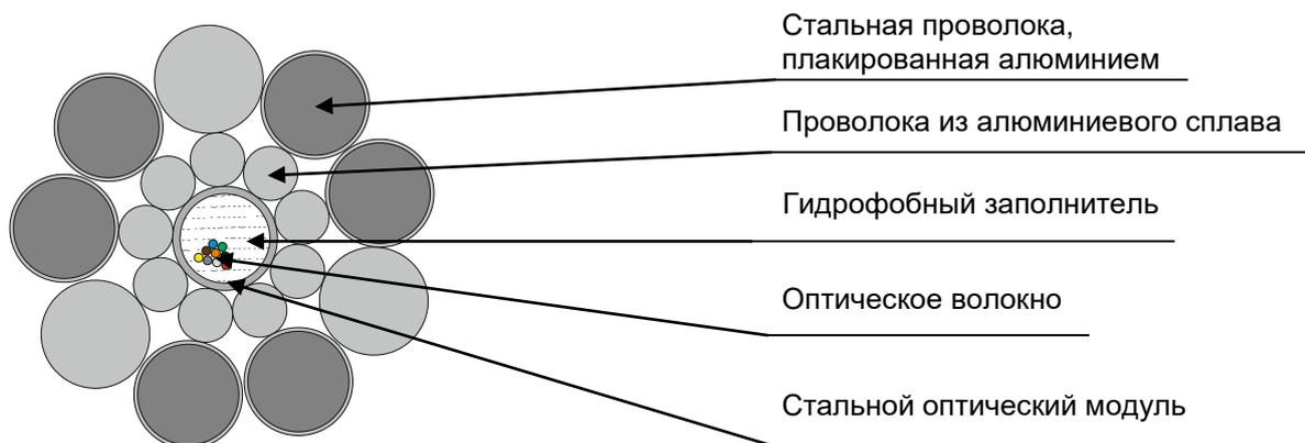
Кабель содержит центральный стальной оптический модуль со свободно уложенными волокнами. Свободное пространство в оптическом модуле заполнено гидрофобным гелем. На центральный оптический модуль спирально накладываются два повива из армирующих проволок.
