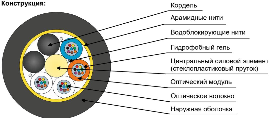
Кабель содержит сердечник модульной конструкции с центральным силовым элементом из диэлектрического стержня со спирально наложенной водоблокирующей нитью, вокруг которого скручены оптические модули со свободно уложенными волокнами. Свободное пространство в оптических модулях заполнено гидрофобным гелем. Сердечник скреплен обмоточными нитями с водоблокирующим свойством. На сердечник спирально накладываются арамидные нити и оболочка из полиэтилена средней плотности.
