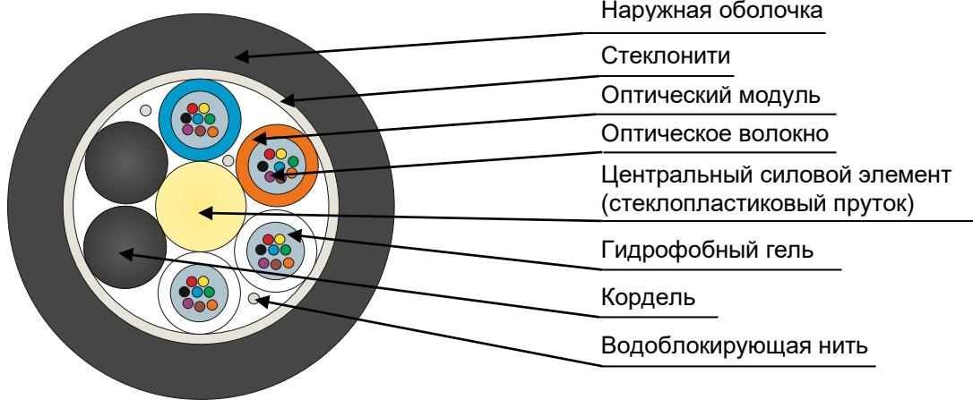
Кабель содержит сердечник модульной конструкции с центральным силовым элементом из диэлектрического стержня со спирально наложенной водоблокирующей нитью, вокруг которого скручены оптические модули со свободно уложенными волокнами. Сердечник скреплен двумя обмоточными нитями с водоблокирующим свойством. На сердечник спирально накладываются стеклонити и оболочка из полиэтилена средней плотности.
