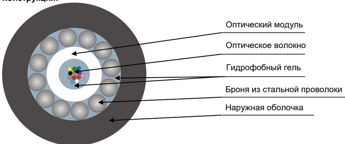
Кабель содержит центральный оптический модуль со свободно уложенными волокнами. Свободное пространство в оптическом модуле заполнено гидрофобным гелем. На центральный оптический модуль спирально накладывается броня из стальных проволок. Свободное пространство между проволоками заполнено гидрофобным гелем. На броню накладывается оболочка из полиэтилена высокой плотности.
