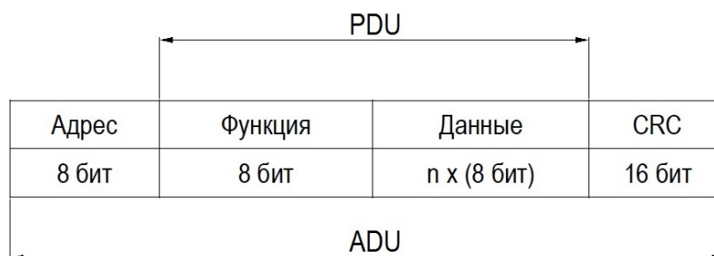
Рис.1 - Формат кадра протокола Modbus RTU; PDU (Protocol Data Unit) – элемент данных протокола; ADU (Application Data Unit) – элемент данных приложения
