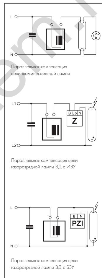
Герметичные, заполненные конденсаторы с прерывателем контакта при избыточном давлении всегда должны использоваться при неблагоприятных условиях окружающей среды (высокая влажность, агрессивная атмосфера, высокие температуры), и если неизвестны рабочая нагрузка и условия электроснабжения, а так же в ситуации, когда обращается особое внимание на электробезопасность.
