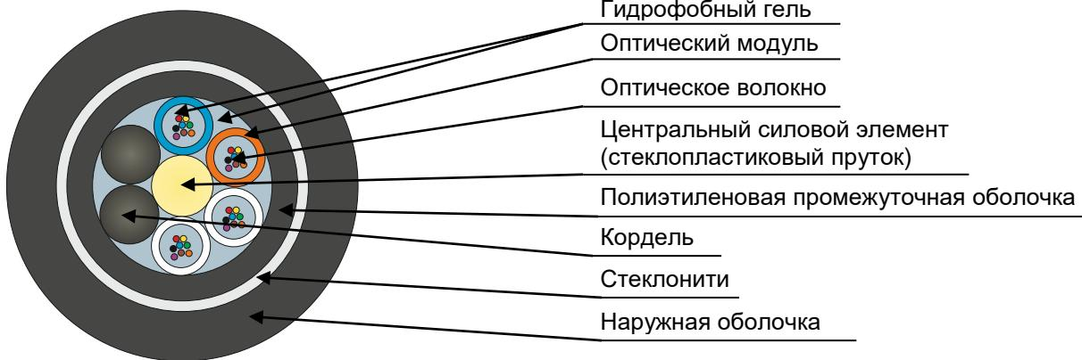
Кабель содержит сердечник модульной конструкции с центральным силовым элементом из диэлектрического стержня, вокруг которого скручены оптические модули со свободноложенными волокнами. Свободное пространство в оптических модулях и в сердечнике кабеля заполнено гидрофобным гелем. На сердечник накладывается промежуточная оболочка из полиэтилена. На промежуточную оболочку спирально накладываются стеклонити. Поверх нитей накладывается оболочка из полиэтилена средней плотности.
