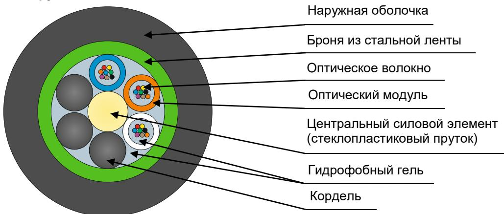
Кабель содержит сердечник модульной конструкции с центральным силовым элементом из диэлектрического стержня, вокруг которого скручены оптические модули со свободноложенными волокнами. Свободное пространство в оптических модулях и в сердечнике кабеля заполнено гидрофобным гелем. На сердечник накладывается броня из гофрированной стальной ленты и оболочка из полиэтилена.
