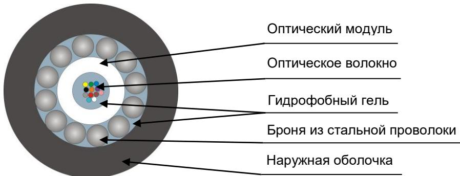
Кабель содержит центральный оптический модуль со свободно уложенными волокнами. Свободное пространство в оптическом модуле заполнено гидрофобным гелем. На центральный оптический модуль спирально накладывается броня из стальных проволок. Свободное пространство между проволоками заполнено гидрофобным гелем. На броню накладывается оболочка из полимерной композиции, не распространяющей горение, не содержащая галогенов с низким дымоудалением.
