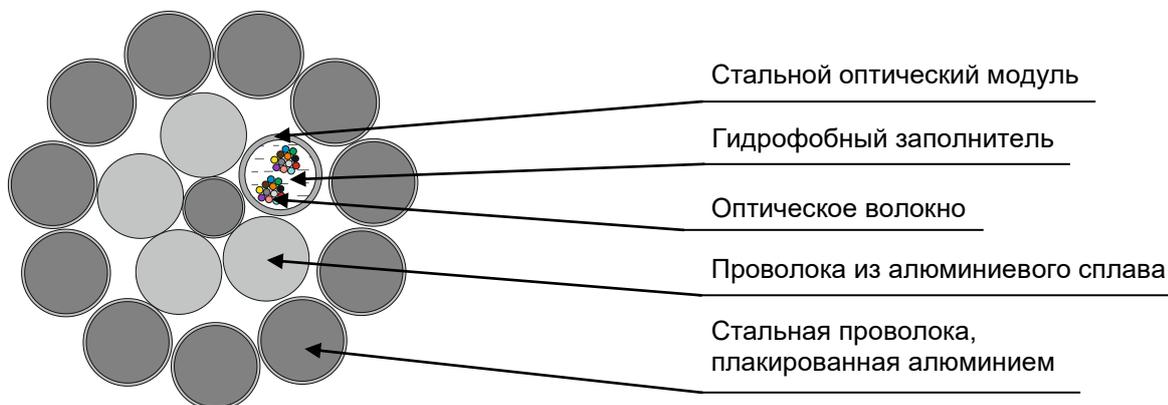
Кабель содержит центральный элемент – стальную проволоку, плакированную алюминием, вокруг которого скручен повив из армирующих проволок и стального оптического модуля со свободно уложенными волокнами. Оптические волокна в модуле сгруппированы в пучки. Каждый пучок волокон имеет обмотку цветной синтетической нитью. Свободное пространство в оптическом модуле заполнено гидрофобным гелем. Поверх спирально накладывается один повив из армирующих проволок.
