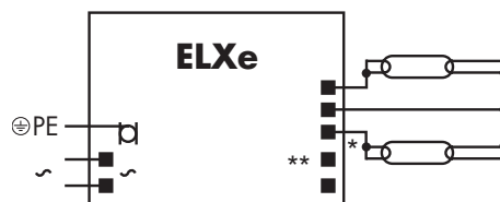
Электрическая схема недиммируемых ELXe 160UV.251 ELXe 180UV.254
