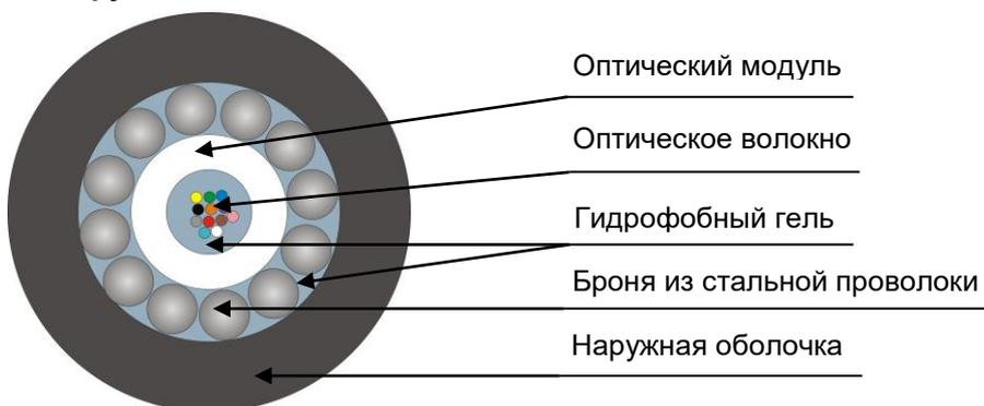
Кабель содержит центральный оптический модуль со свободно уложенными волокнами. Свободное пространство в оптическом модуле заполнено гидрофобным гелем. На центральный оптический модуль спирально накладывается броня из стальных проволок. Свободное пространство между проволоками заполнено гидрофобным гелем. На броню накладывается оболочка из полимерной композиции, не распространяющей горение при одиночной прокладке.
